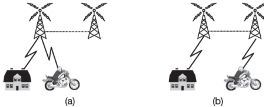
Figura 1.20 Handover de telefone móvel (a) antes e (b) depois.
