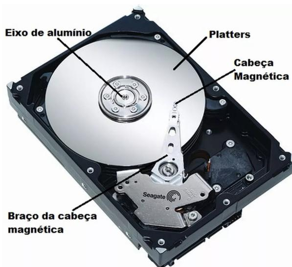
O motor do disco rígido faz com que o conjunto dos discos gire a uma velocidade elevadíssima: pelo menos 3600rpm. Discos modernos giram a 4800rpm, 7200rpm ou mais.
